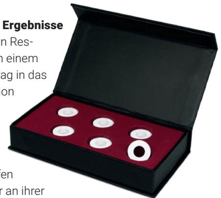
Thermoelemente in Sinteröfen erfassen die Temperatur nur an ihrer Position. Kalibrierringe erfassen den Wärmeeintrag an der Position, an der sich auch das Werkstück befindet und ermöglichen die Bestimmung des Temperaturfeldes. Ein kalibrierter Ofen liefert optimale Sinterergebnisse und sichert einen gleichbleibend hohen Qualitätsstandard.
